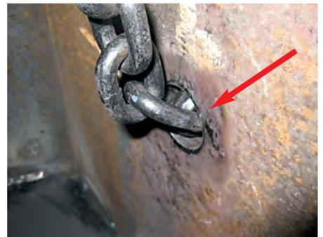
Abb. 4a und b: Knebelkette und Kerbwirkung durch die Kante auf das erste Kettenglied
