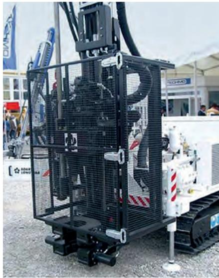
Abb. 11: Schutzeinrichtung an Bohrgeräten (Foto: BG BAU/Leisering)
