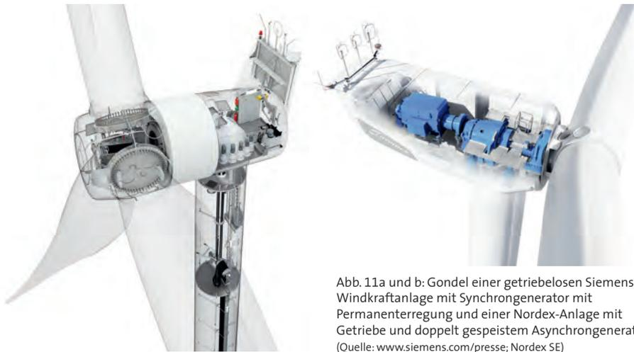
Abb. 11a und b: Gondel einer getriebelosen Siemens-Windkraftanlage mit Synchrongenerator mit Permanentterregung und einer Nordex-Anlage mit Getriebe und doppelt gespeistem Asynchrongenerator (Quelle: www.siemens.com/presse; Nordex SE)
