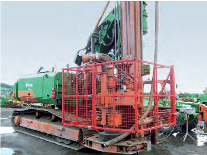
Abb. 7: Beweglich trennende Schutzeinrichtung (Foto: BG BAU/Winkler/Leisering)
