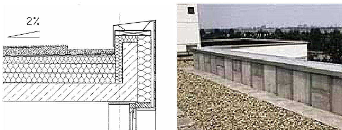
Abbildung 6.5-6: Schnitt durch eine Attikaverblechung bei einer Holzfassade bzw. Attikaverblechung mit Kiesdach
